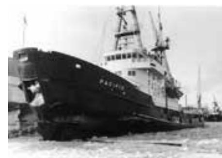
1966 Eisbrecher Pacific mit Polarhorn // Ice-breaker Pacific with polar horn
