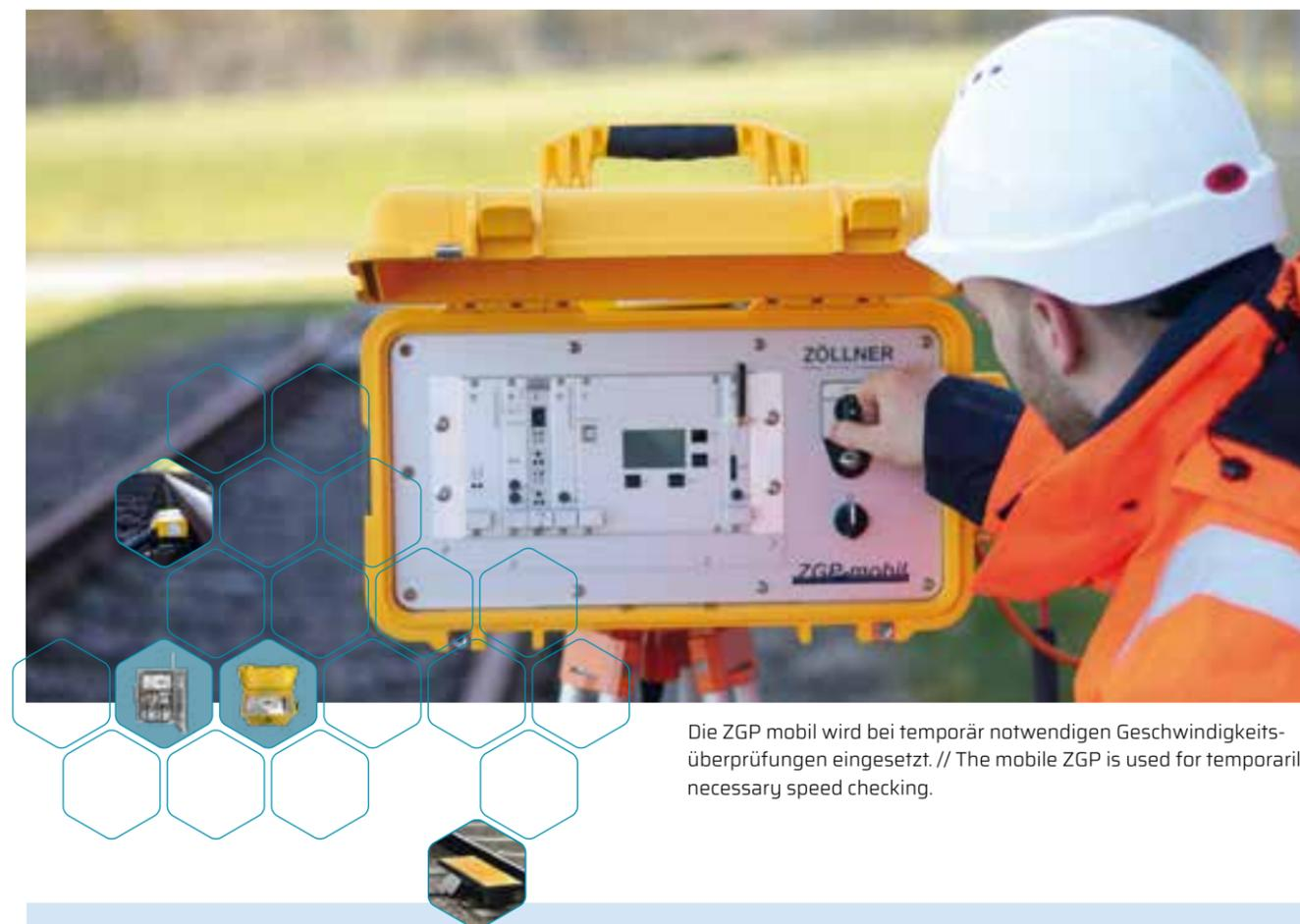
Die ZGP mobil wird bei temporär notwendigen Geschwindigkeitsüberprüfungen eingesetzt. // The mobile ZGP is used for temporarily necessary speed checking.
